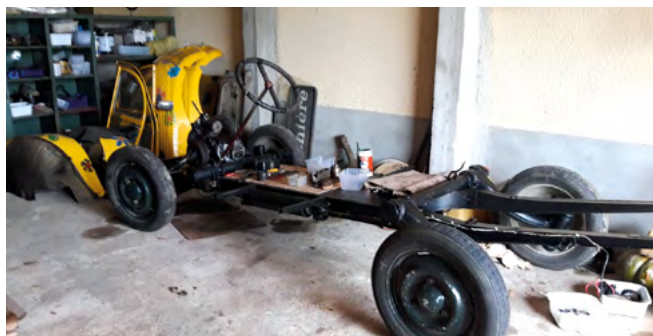
Remise en état du châssis
